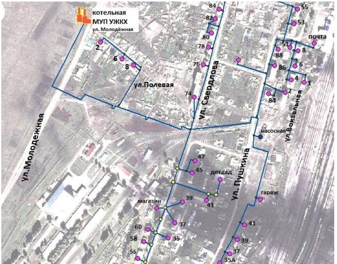
Рис.5. Схема тепловой сети котельной по ул. Молодёжная, 8а, лист 1.
